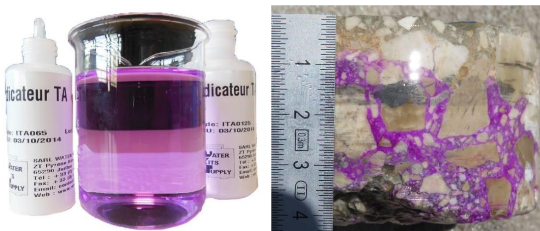
Figure 5 : Indicateur TA - Exemple d'essai de mesure avec profondeur moyenne de carbonatation égale à 12 mm
