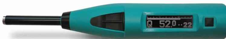
Figure 6 : Scléromètre Silver Schmidt N
